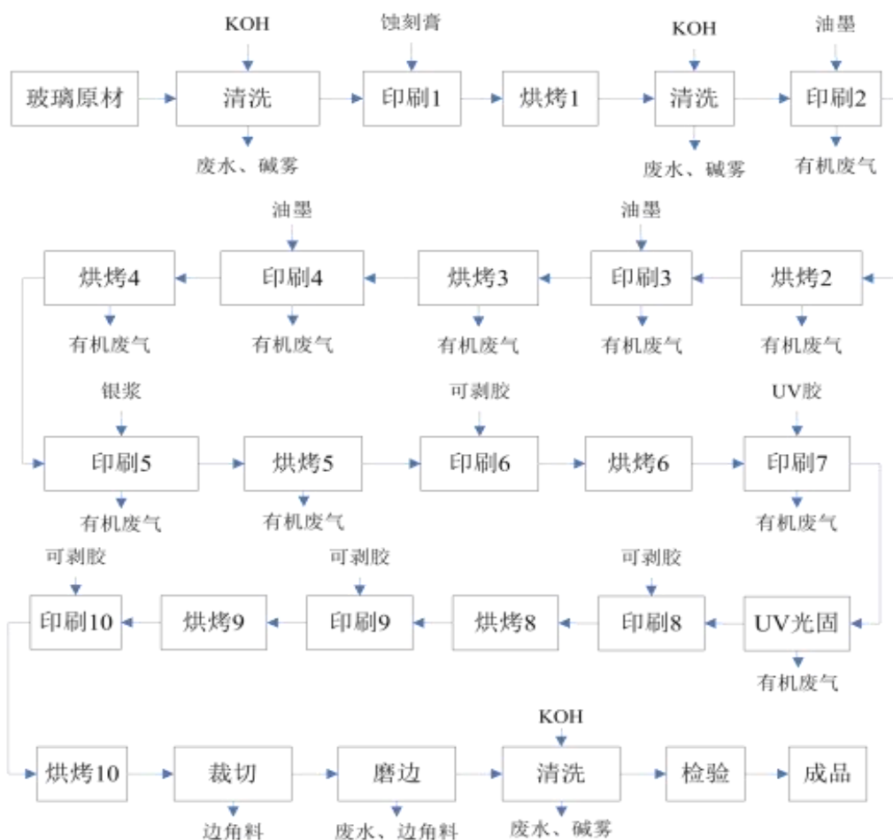
图 2.4.2 二、三期工程生产工艺流程及产污环节示意图
