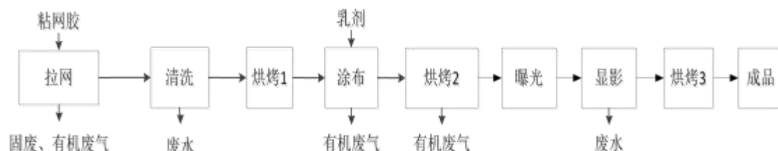
图 2.4.3 四期工程生产工艺流程及产污环节示意图
