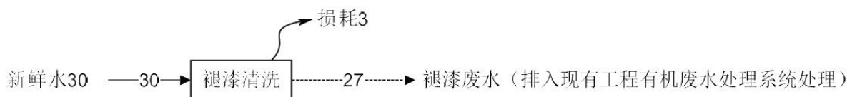
图 2.2 本改扩建工程给排水平衡图
