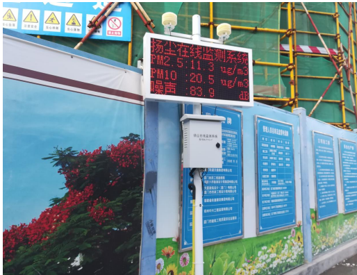
扬尘在线监测系统
