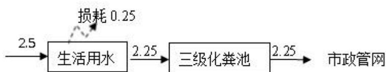
图 2.6 扩建项目用排水平衡图（单位：t/d）
