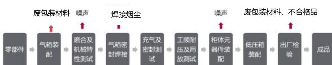
图 2.8 GX1/2/3 项目生产工艺流程及产污环节图
